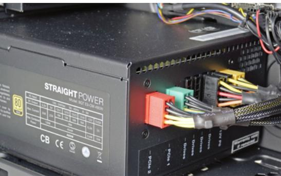
Sechs von zehn Testkandidaten verbauen ein **modulares Netzteil**, das spart unnötigen Kabelsalat. Alle Hersteller liefern die nicht verwendeten Netzteil-Kabel mit, genau wie übrigens auch Treiber-CDs, Handbücher und etwaiges Gehäuse-Zubehör.
