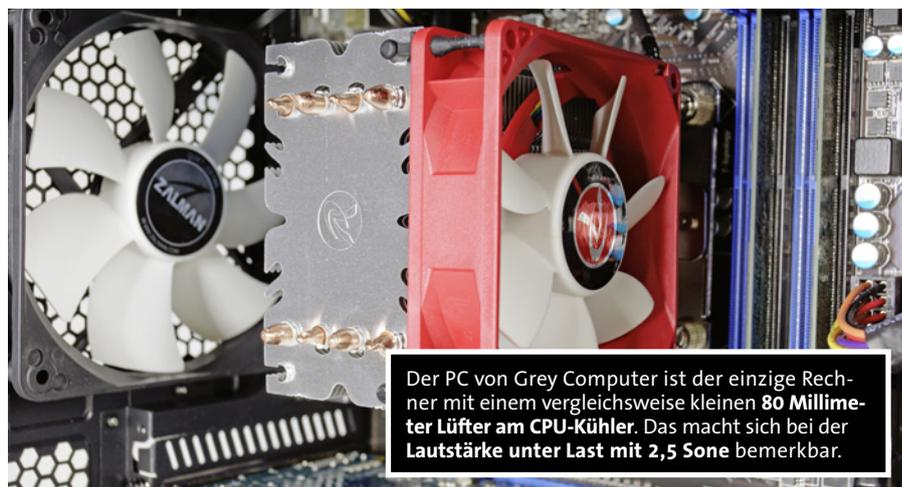
Der PC von Grey Computer ist der einzige Rechner mit einem vergleichsweise kleinen **80 Millimeter Lüfter am CPU-Kühler**. Das macht sich bei der Lautstärke unter Last mit **2,5 Sone** bemerkbar.
