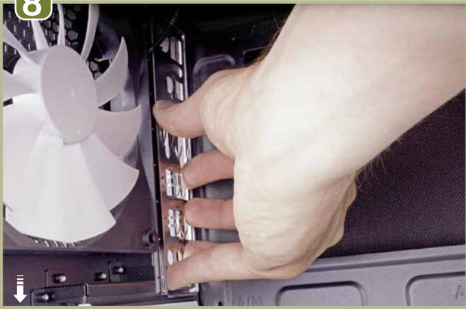
Anschließend installieren wir das bei jedem Mainboard mitgelieferte, sogenannte I/O-Panel, das passende Aussparungen für die externen Anschlüsse des Mainboards hat und diese besser kennzeichnet. Dafür drücken wir die Platte an der rechteckigen Aussparung der Gehäuserückseite gleichmäßig gegen die Innenseite, bis sie einrastet (die Audioanschlüsse zeigen bei stehendem Gehäuse in der Regel nach unten).
