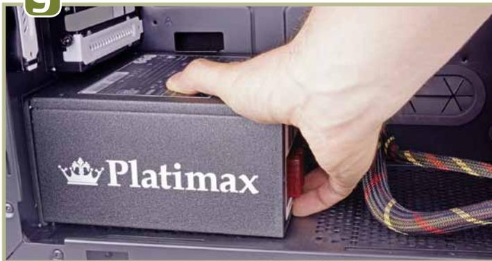
Der nächste Schritt ist der Einbau des Netzteils. Dabei können Sie die Stromversorgung entweder mit dem Lüfter nach oben oder nach unten einbauen. Der Vorteil der ersten Methode besteht darin, dass das Netzteil so einen Teil der warmen Luft der anderen Komponenten absaugt und nach hinten aus dem Gehäuse schaufelt. Allerdings bekommt das Netzteil so keine Frischluft und wird deshalb schlechter gekühlt.
