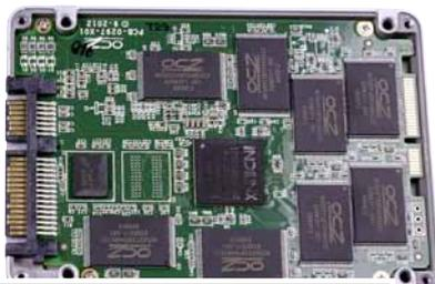
Sandisks Ultra Plus SSD (links) nutzt als einzige SSD im Test bereits Speicherchips mit nur 19 Nanometer Strukturweite, ein Grund für die winzigen Ausmaße der Platine im 2,5-Zoll-Gehäuse. Die meisten SSD-Platinen wie bei OCZs Vector (rechts) belegen deutlich mehr Platz.
