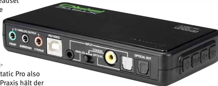
*Die Sound Control Unit kann sowohl an optische Soundquellen, als auch an analoge und koaxiale Kabel angeschlossen werden.*
