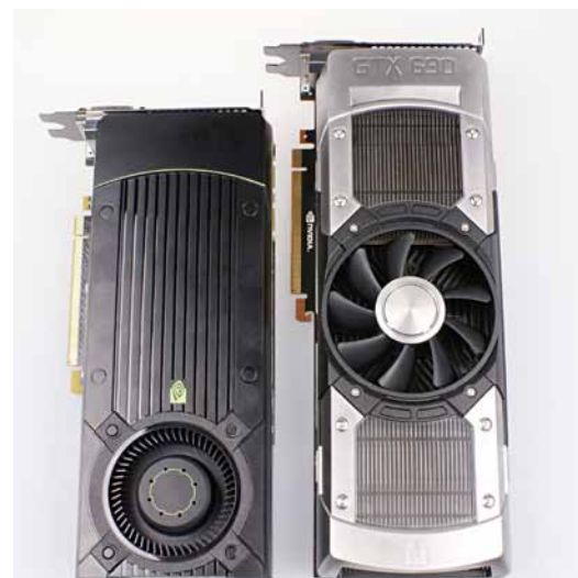
Die Geforce GTX 690 (rechts) passt mit 28 cm nicht in kleine Gehäuse, die GTX 670 benötigt nur knapp 24 cm.
