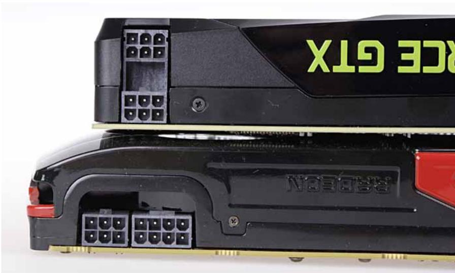
Der niedrigere **Stromverbrauch** der GTX 680 zeigt sich auch bei den beiden sechspoligen Stromanschlüssen. Die HD 7970 (unten) braucht ein sechs- und ein achtpoliges Kabels.
