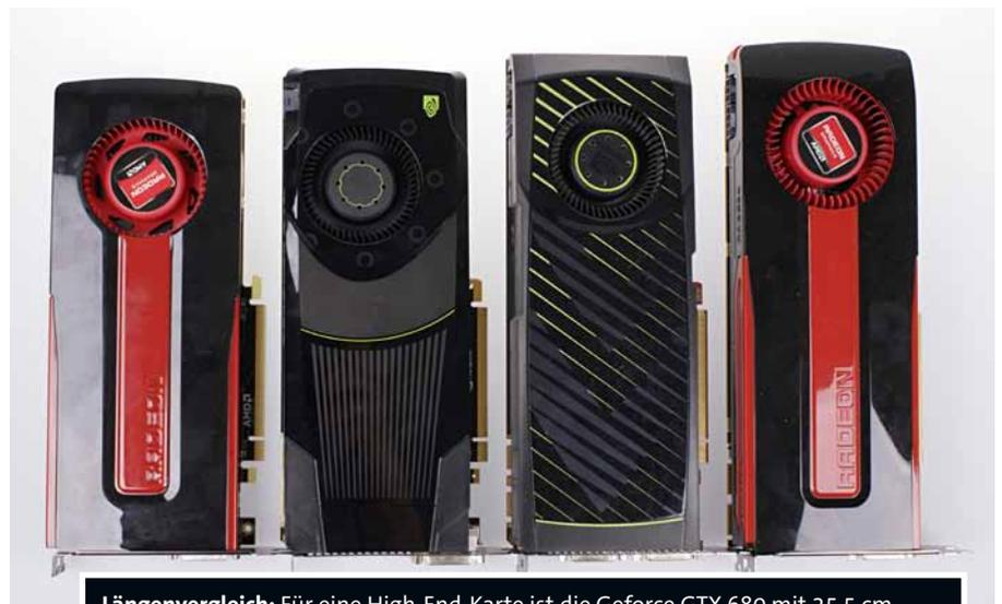
**Längenvergleich:** Für eine High-End-Karte ist die Geforce GTX 680 mit 25,5 cm (zweite von links) erstaunlich kurz und kaum länger als die HD 7870 (links, 25 cm). GTX 580 und HD 7970 daneben passen in deutlich weniger Gehäuse.
