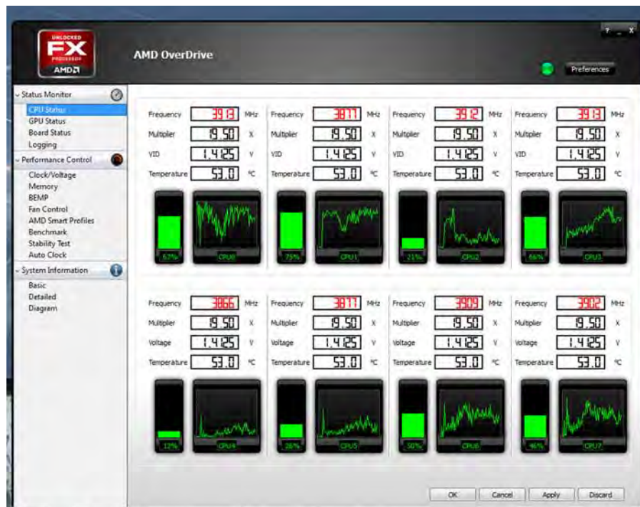
Plattform-Vorteil: Mit AMDs hauseigenem Overdrive-Tool überwachen Sie bequem FX-CPU, AM3+-Mainboard sowie Radeon-Grafikkarte und übertakten diese auf Wunsch.
