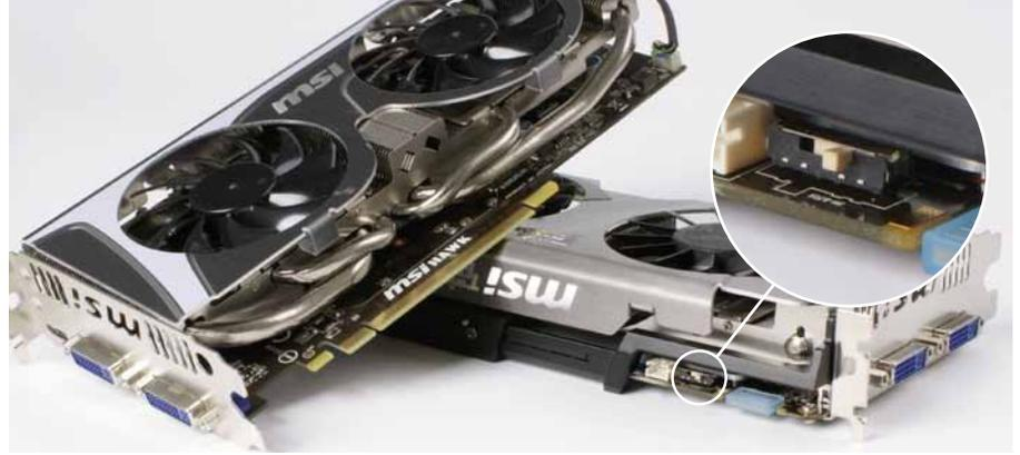
Bei den **Hawk-Karten** kombiniert MSI oft mehr Leistung mit leisen Lüftern. Was bei der GTX 460 Hawk (links) noch funktionierte, klappt bei der 560 Hawk (rechts) trotz zwei Lüftermodi nicht.
