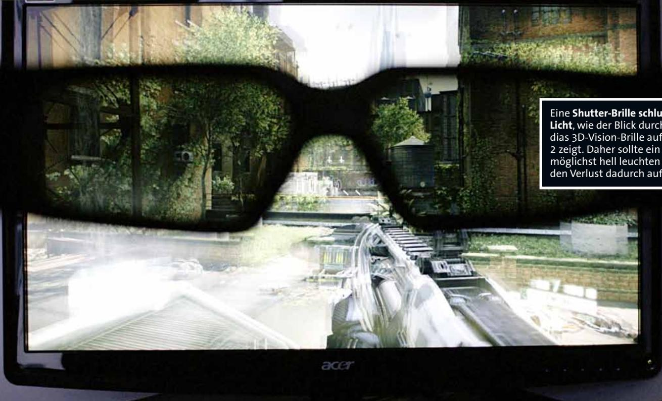
Eine **Shutter-Brille schluckt viel Licht**, wie der Blick durch Nvidias 3D-Vision-Brille auf Crysis 2 zeigt. Daher sollte ein 3D-TFT möglichst hell leuchten und den Verlust dadurch auffangen.
