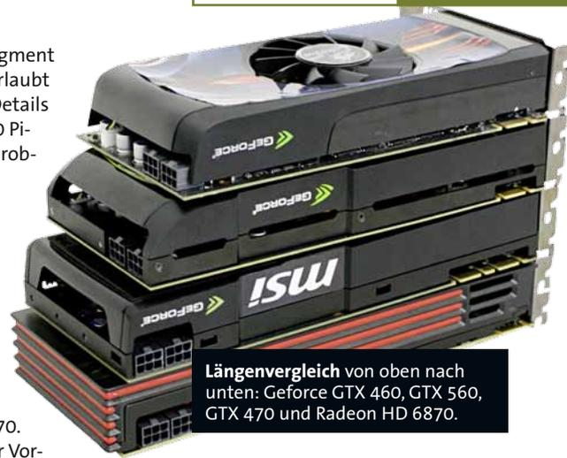
**Längenvergleich** von oben nach unten: Geforce GTX 460, GTX 560, GTX 470 und Radeon HD 6870.
