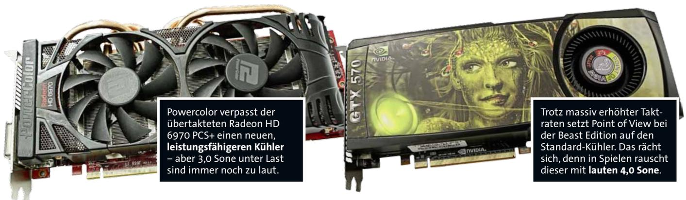
Powercolor verpasst der übertakteten Radeon HD 6970 PCS+ einen neuen, leistungsfähigeren Kühler – aber 3,0 Sone unter Last sind immer noch zu laut.
