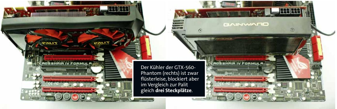
Der Kühler der GTX-560-Phantom (rechts) ist zwar flüsterleise, blockiert aber im Vergleich zur Palit gleich drei Steckplätze.
