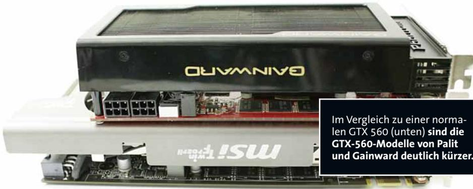
Im Vergleich zu einer normalen GTX 560 (unten) sind die GTX-560-Modelle von Palit und Gainward deutlich kürzer.
