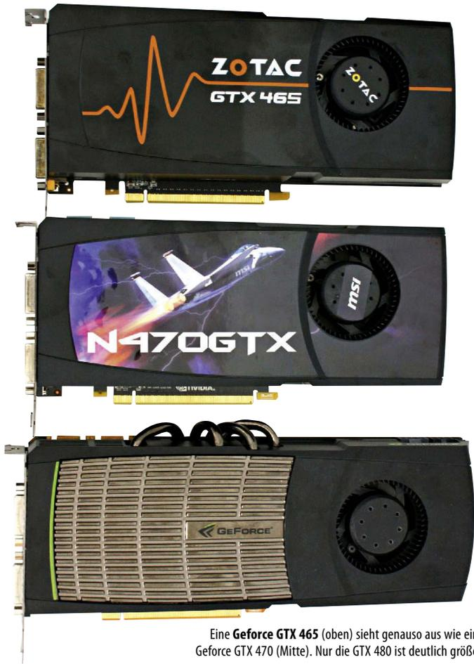
Eine GeForce GTX 465 (oben) sieht genauso aus wie eine GeForce GTX 470 (Mitte). Nur die GTX 480 ist deutlich größer.
