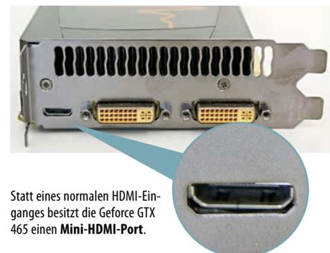
Statt eines normalen HDMI-Einganges besitzt die GeForce GTX 465 einen Mini-HDMI-Port.
