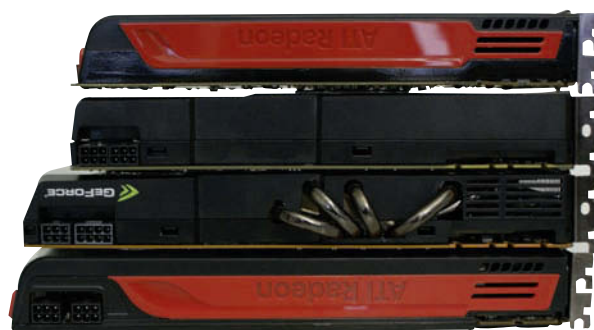
High-End-Grafikkarten brauchen ein großes Gehäuse. Von oben nach unten: Radeon HD 5850, Geforce GTX 470 , Geforce GTX 480 und Radeon HD 5870 (beide rund 26,5 cm).
