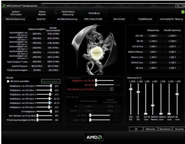
Mit Hilfe von AMDs Overdrive-Tool können Sie die gewünschte **Taktfrequenz der einzelnen Rechenkerne** des Phenom II X6 1090T sogar unterschiedlich hoch einstellen - ein Fest für Übertakter!
