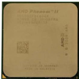
Wie das »T« in der Modellnummer andeutet, besteht die größte Änderung beim **Phenom II X6 1090T** aus einer »Turbo Core« genannten Technik zur automatischen Taktsteigerung, solange nicht alle sechs Cores ausgelastet sind und es die Hitzeentwicklung zulässt. »Turbo Core« erinnert stark an Intels von der Core-i7-Serie bekannten »Turbo Boost«, funktioniert im Detail aber anders. Dazu kommt beim **Phenom II X6 1090T** ein freier Multiplikator, der Über-taktungsversuche erleichtert.
