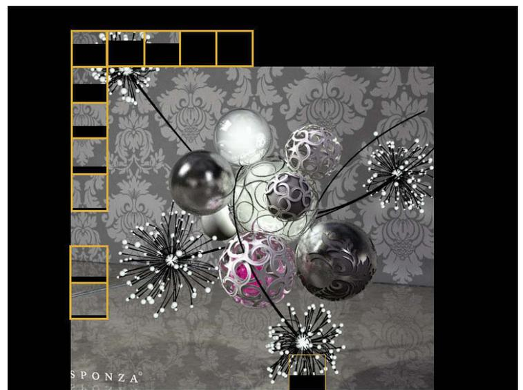
Cinebench verteilt die Berechnung des Bildes auf alle vorhandenen CPU-Kerne. Beim Phenom II X6 (links) in sechs Teilaufgaben (orange Quadrate), beim Core i7 980X (rechts) dank Hyperthreading sogar in zwölf.
