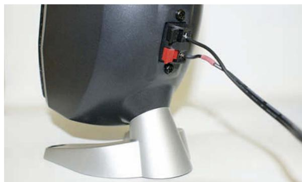
Geklemmte Anschlüsse für die Lautsprecherkabel haben Vorteile, falls die Strippe ein Mal kaputt geht oder Sie die Boxen weiter entfernt aufstellen wollen.
