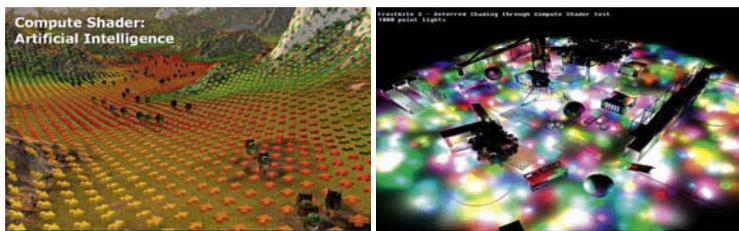
AMD hält es für möglich, dass die KI-Wegfindung künftig über die Grafikkarte läuft. DICE realisiert in seiner kommenden Frostbite-Engine 2.0 über den Compute Shader bis zu 1.000 dynamische Lichtquellen.
