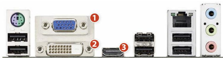
Um die integrierte Grafik nutzen zu können, benötigen Sie ein neues **Mainboard mit Videoausgängen**. Unser Testmuster von Intel etwa bietet VGA 1, DVI 2 und HDMI 3, aber keinen Displayport-Ausgang.
