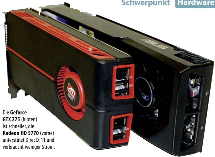
Die **Geforce GTX 275** (hinten) ist schneller, die **Radeon HD 5770** (vorne) unterstützt DirectX 11 und verbraucht weniger Strom.
