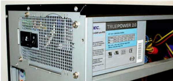
Die gängigen ATX-Netzteile und Gehäuse passen problemlos zueinander.
