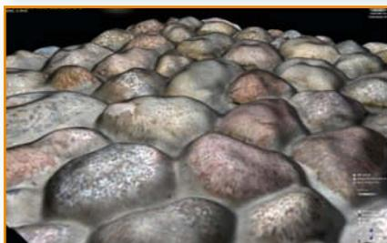
Das heute veraltete **Bump Mapping** (oberer Screenshot) erzeugt mittels Schattierungen nur die Illusion einer plastischen Oberfläche. Das modernere **Parallax Occlusion Mapping** (auch: Virtual Displacement Mapping) ruft zwar schon einen wesentlich realistischeren Tiefeneindruck (mittlerer Screenshot) hervor, mit DirectX 11 kommt dann aber **Tessellation** (unterer Screenshot) und damit wirklich plastische Oberflächen, die von der Grafikkarte sogar dynamisch verfeinert werden.
