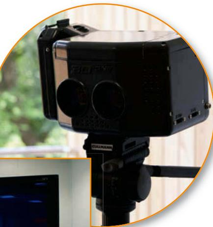
Spezielle 3D-Kameras mit zwei Linsen erstellen stereoskopisches Bildmaterial bereits bei der Aufnahme.
