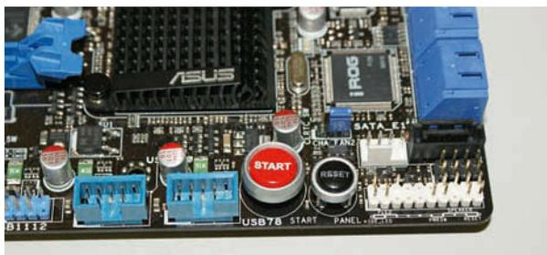
Auf dem Mainboard angebrachte Ein-/Aus-, Reset- und Clear-CMOS-Schalter zum Zurücksetzen der Bios-Einstellungen erleichtern Übertaktern die Arbeit.
