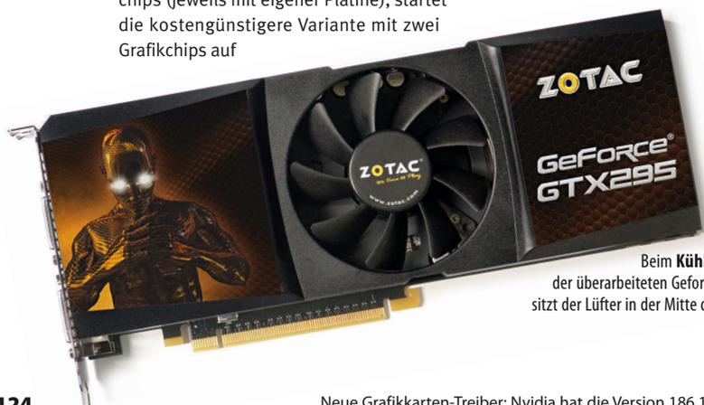
Beim **Kühlaggregat** der überarbeiteten Geforce GTX 295 sitzt der Lüfter in der Mitte der Platine.
