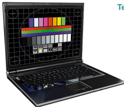
Als erstes Notebook mit Nvidias neuem Grafikchip Geforce GTX 260M schlägt das Cyber System **SX15TS** (1.760 Euro) in unserem Hardware-Labor auf. Doch der Name GTX täuscht in diesem Fall, denn der GTX 260M und GTX 280M sind nur leicht aufgebohrte Geforce-9-Chips – also keine GT200-Ableger. Unser Testgerät trat mit dem Doppelkern-Prozessor Core 2 Duo T9600 (2,66 GHz), 4,0 GByte RAM und einer Geforce GTX 260M an. Die Festplatte fasst 320 GByte.
