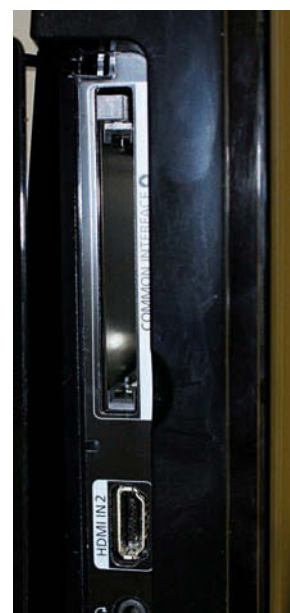
Der Kabel-TV-Tuner von Samsungs T220HD ist sogar mit einem Schacht für CI-Module ausgestattet, um verschlüsselte TV-Sender wie etwa Premiere zu empfangen.
