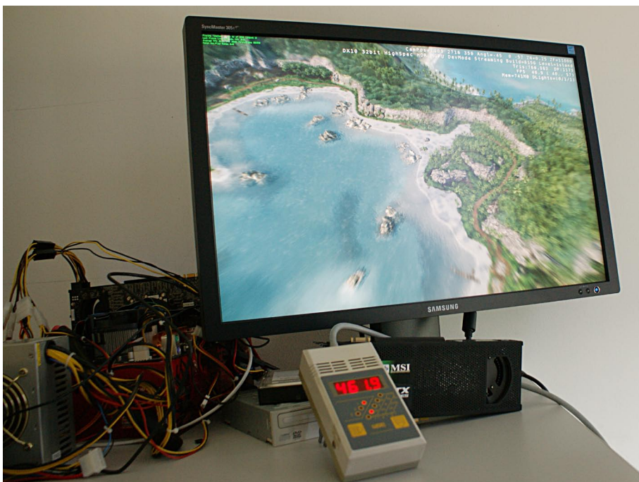
Mit der schnellsten Grafikkarte im Test, dem Zwei-Chip-Monster GeForce GTX 295, frisst unser Testsystem unter Volllast bis zu 470 Watt Strom (Crysis-Benchmark in 2560x1600 mit 16facher Kantenglättung und achtfachem anisotropen Texturfilter).
