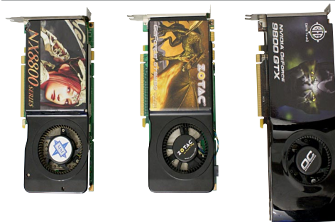
Die Geforce GTS 250 (Mitte) ähnelt optisch der Geforce 8800 GTS (links), im Inneren sitzt aber derselbe Chip wie bei der Geforce 9800 GTX+ (rechts).
