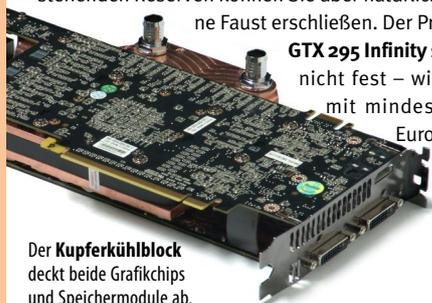
Der **Kupferkühlblock** deckt beide Grafikchips und Speichermodule ab.
