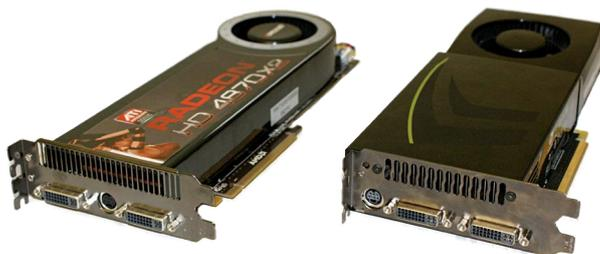
Im **High-End-Segment** greifen Sie besser zur Doppel-Radeon HD 4870 X2 (links) oder der Geforce GTX 280 (rechts) als zu zwei einzelnen, günstigeren Grafikkarten.
