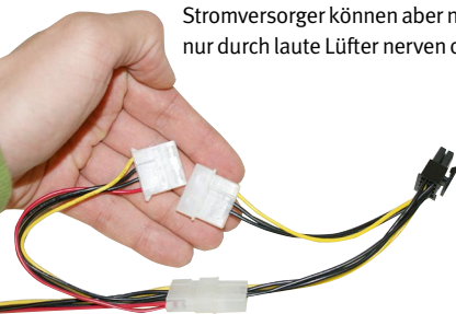
Nahezu jeder Grafikkarte liegt ein Adapter von den herkömmlichen Molex-Stromsteckern auf PCIe-Stecker bei.
