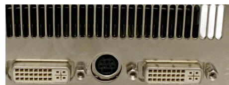
Jeder DVI-Anschluss steuert bis zu 2560 mal 1600 Pixel an. Ein wertvolles HDMI-Kabel samt Adapter sind mit dabei.
