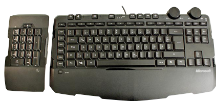
Den Ziffernblock der Sidewinder X6 verpflanzen Sie mittels Magnethalterung auch auf die linke Tastaturseite.
