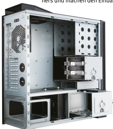
Gehäuse-Inneres mal anders: Netzteil unten, herausziehbare Festplatten-Schächte und isolierte Gehäuse-Türen.
