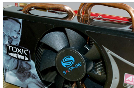
Sapphires eigenes 2-Slot-Kühlsystem mit großem Rotor und drei Heatpipes arbeitet in jeder Situation leise.
