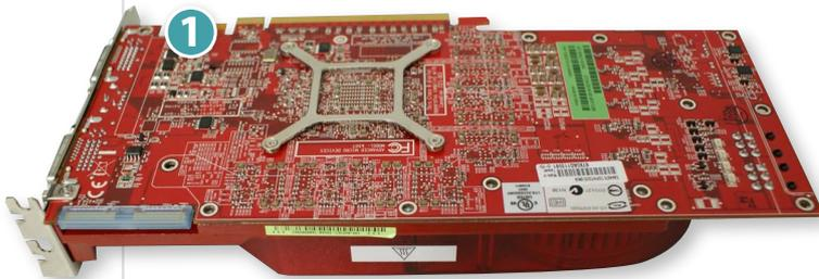
Zehn Schrauben verbinden den massiven ATI-Kühlkörper mit der Platine, das heißt: alle zehn Schrauben lösen. Da diese teils ziemlich fest angezogen sind, brauchen Sie einen perfekt sitzenden Schraubenzieher, ansonsten zerstören Sie die Köpfe.
