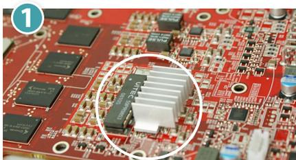
Kleben Sie die länglichen Kühlrippen auf die Spannungswandler. Entfernen Sie dazu die Schutzfolie der Kühlkörper und pressen Sie diese mit leichtem Druck auf die Spannungswandler.
