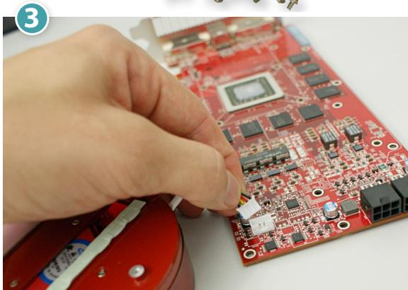
Vorsicht: Noch sind Platine und Lüfter mit dem Stromkabel verbunden. Dieses steckt fest in der zugehörigen Buchse. Ziehen Sie es also sanft, aber bestimmt heraus.
