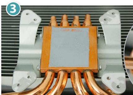
Bevor Sie den Kühler mit der Platine verbinden, entfernen Sie die Schutzfolie des Kühleraufsatzes und auf dem Kupferblock.
