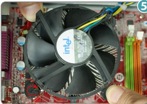
Um den Standardkühler zu montieren, positionieren Sie ihn so, dass die Kabel in Richtung des passenden Mainboard-Anschlusses über den Speicher-Slots zeigen. Die vier Befestigungsstifte des Kühlers müssen über den Löchern im Mainboard liegen und gegen die aufgedruckte Pfeilrichtung gedreht sein. Dann drücken Sie jeweils zwei gegenüberliegende Stifte herunter, bis diese einrasten. Dafür ist etwas Kraft nötig, und das Mainboard biegt sich leicht durch, daher ist eine flexible Unterlage von Vorteil.
