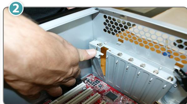
2 Entfernen Sie die Schraube und kippen Sie die Blende leicht in Richtung Gehäuseinneres. Eventuell müssen Sie auch die nächste Schraube vorher etwas lösen.
