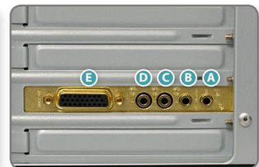
A Mikrofon-/Line-In-Eingang sowie Digitalschnittstelle bei angestecktem Koaxialkabel.
