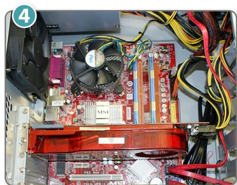
Sitzt die Grafikkarte im Slot, befestigen Sie sie mit zwei Schrauben am Gehäuse. Teils müssen Sie die Karte dafür vorsichtig in Richtung Gehäuserückseite drücken, bis die Schrauben richtig passen.
