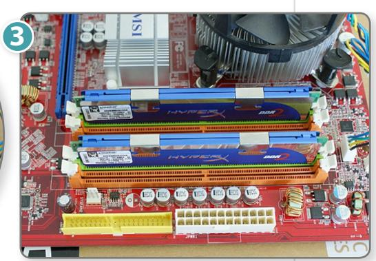
Um den Arbeitsspeicher einzubauen, klappen Sie zuerst die weißen Befestigungsflanschen an den Steckplätzen nach außen. Nehmen Sie nun einen der Speicherriegel und führen Sie ihn in die seitlichen Schienen des Steckplatzes. Überprüfen Sie, ob die Einkerbung in der Kontaktleiste des Riegels über der passenden Nase im Steckplatz liegt. Ist das nicht der Fall, haben Sie den Riegel falsch herum in der Hand und müssen ihn umdrehen.
