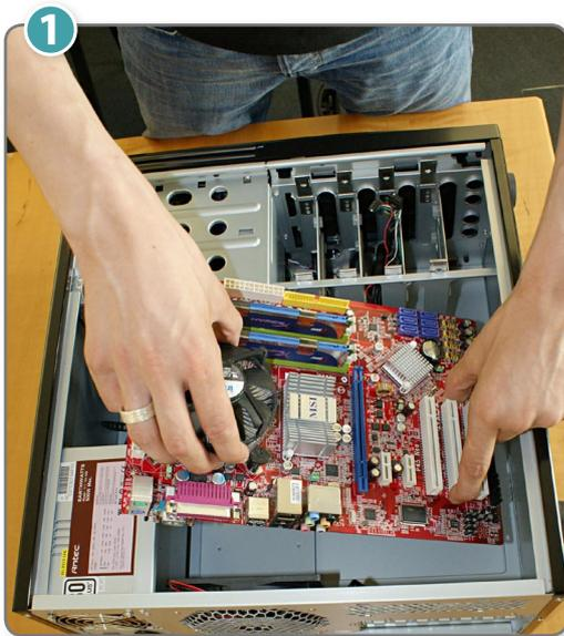
Im nächsten Schritt bauen Sie das Mainboard samt CPU, Kühler und Arbeitsspeicher ins Gehäuse ein. Fassen Sie es dazu am Kühler sowie einem der Steckplätze, die das Gewicht locker tragen können. Falls das Mainboard nicht waagrecht ins Gehäuse passt, kippen Sie es leicht und senken Sie die eine Seite zuerst ab. Achten Sie darauf, möglichst nirgends anzustoßen. Dabei hilft es, wenn Sie vorher die Stromleitungen des Netzteils sowie die Kabel der Gehäuseanschlüsse aus dem Weg räumen.
