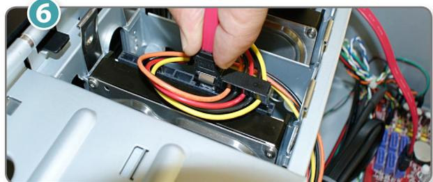
**6** Das andere Ende der SATA-Kabel stecken Sie an den entsprechenden Anschluss der Festplatten. Wie beim Stromanschluss haben auch die SATA-Stecker der Datenleitungen eine L-Form, sodass die Kabel nur in eine Richtung in den Anschluss passen.
