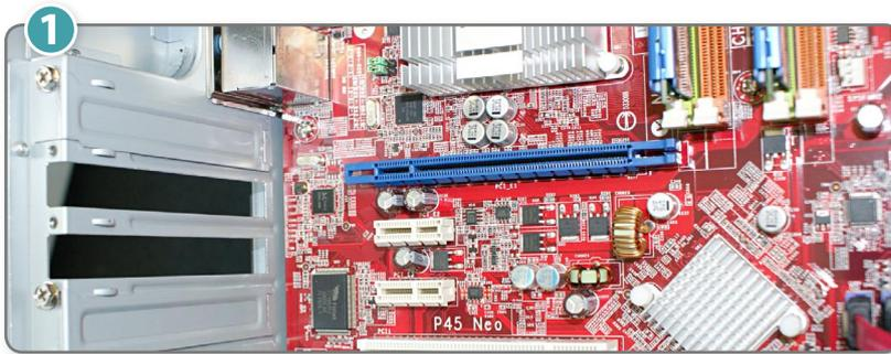
Das MSI P45 Neo-F besitzt einen PCI-Express-16x-Steckplatz für Grafikkarten. Im Bild ist das der blaue Slot schräg unter den RAM-Slots. Andere Mainboards verwenden andere Farben, die Form bleibt aber immer gleich. Um Platz für die Anschlüsse und den zwei Slot hohen Kühler der Radeon HD 4870 zu schaffen, entfernen Sie die beiden Slotbleche in der Gehäuserückwand auf die gleiche Weise wie beim Einbau der Soundkarte.
