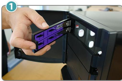
1 Entfernen Sie zunächst eine der Blenden aus der Front des **Sonata 3** und nehmen Sie die violetten Schienen zur Befestigung des Brenners heraus.
