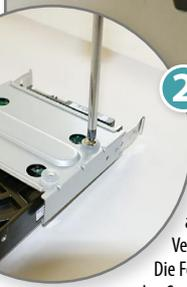
**2** Das Antec **Sonata 3** bringt eigene Festplattenrahmen mit, mit denen Sie die Speicherlaufwerke vom Gehäuse entkoppelt befestigen. So übertragen sich die Schwingungen der Festplatten im Betrieb nicht auf das **Sonata 3**, was sonst zu einer deutlich hörbaren Verstärkung des Laufgeräusches führen kann.
