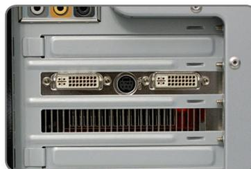
Die Radeon HD 4870 besitzt zwei digitale DVI-Ausgänge (weiß) zum Anschluss aktueller TFT-Displays. Per beiliegendem Adapter schließen Sie auch Monitore mit analoger VGA-Schnittstelle an. Zudem liegt ein DVI-HDMI-Adapter bei. Der schwarze Anschluss in der Mitte liefert analoges Video-Out sowie HDTV per Komponentenkabelpeitsche.
