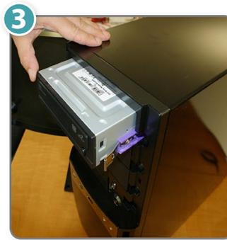
3 Der Strom- und Datenanschluss des Brenners funktioniert genau wie bei den Festplatten. Sie benötigen ein Stromkabel mit SATA-Stecker sowie ein SATA-Datenkabel, das Sie mit einem der noch freien SATA-Anschlüsse des Mainboards verbinden.
