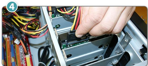
**4** Nun schließen Sie beide Festplatten am Netzteil an. Die SATA-Stromstecker besitzen eine L-Form, sodass Sie dies nicht verkehrt herum anschließen können.
