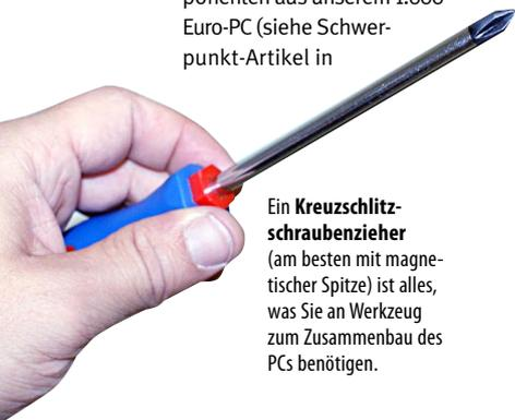
Ein **Kreuzschlitzschraubenzieher** (am besten mit magnetischer Spitze) ist alles, was Sie an Werkzeug zum Zusammenbau des PCs benötigen.
