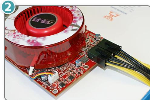
Verbinden Sie nun die beiden sechspoligen Stromanschlüsse des Netzteils mit den entsprechenden Eingängen auf der Grafikkarte. Die Stecker passen aufgrund der Haltenasen nur in der korrekten Richtung. Besitzen Sie ein älteres Netzteil mit nur einem sechspoligen PCI-Express-Stromanschluss, liegen den Grafikkarten meist passende Adapter bei.
