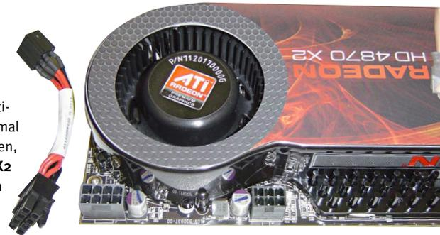
Geforce GTX 280 und Radeon HD 4870 X2 benötigen einen zusätzlichen achtpoligen Stromanschluss. Ein **passender Adapter** für ältere Netzteile liegt aber nicht jeder Karte bei.
