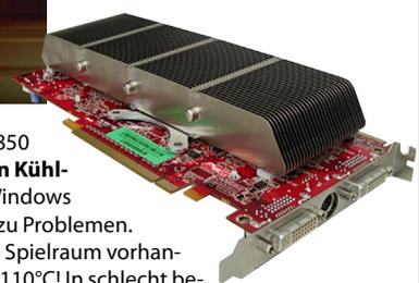
Normalerweise sitzt auf einer Geforce 9800 GT ein schmaler Eins-Slot-Kühler, Sparkle ersetzt ihn durch ein größeres Modell. Lohn der Mühe: Im Vergleich zum Standard-Design der Zotac-Platine (96°C) **sinkt die Temperatur** um 39°C auf 57°C.
