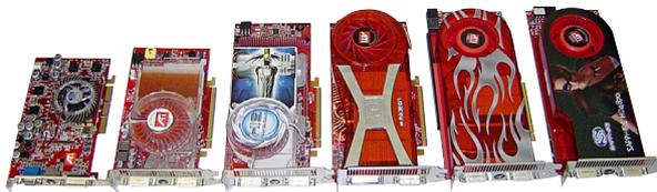
Ahnen der HD 4870 (von links): Radeon 9700, X850, X1800, X1950 und HD 2900.
