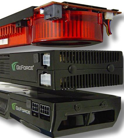
Von oben nach unten: HD 3870 X2, 9800 GX2 und GTX 280 haben allesamt **zwei Stromanschlüsse**.
