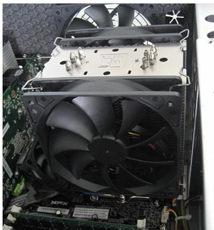
Den um fast **900 MHz übertakteten Prozessor** kühlen zwei 120-mm-Lüfter und ein massiver Aluminiumblock.
