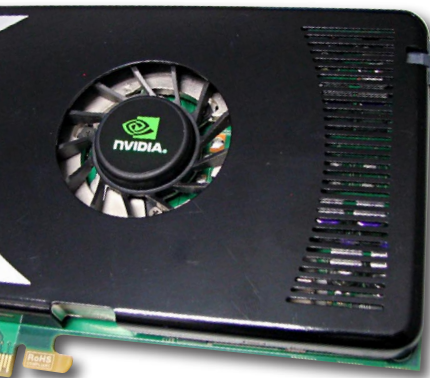
Bei einigen 8800-GT-Karten rattert der Lüfter bei niedriger Drehzahl . Tauschen Sie die Platine in diesem Fall um.
