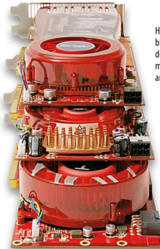
Heckspoiler: Zwei der drei getesteten AMD-Karten blockieren mit ihrem **Kühlkörper** den Steckplatz neben der Grafikkarte (links), aber nur die Radeon HD 2900 GT macht Lärm (links unten). Nvidias flache Geforce 8800 GT arbeitet **flüsterleise** (rechts).
