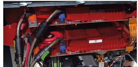
Die Radeon HD 3870 X2 ist **zu lang** für viele normale PC-Gehäuse.
