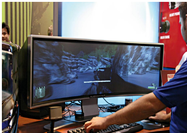
Alienware zeigte auf der CES einen gigantischen 42-Zoll-Breitbildmonitor mit 2880 mal 900 Pixeln. Intern arbeitet das gebogene Gerät mit Rückprojektion.
