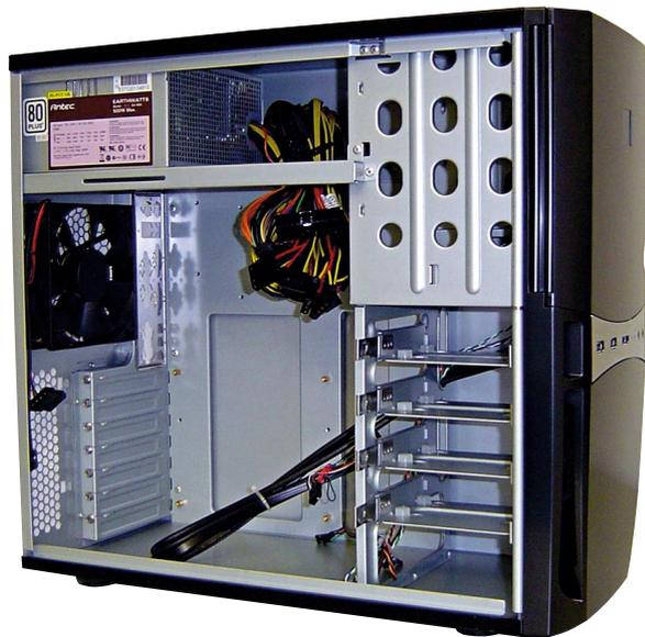
Für 100 Euro ein starkes Komplettpaket: **Antec Sonata 3** mit leisem 500-Watt-Netzteil, regelbarem Gehäuselüfter sowie entkoppelten Festplattenhalterungen für mehr Laufruhe.
