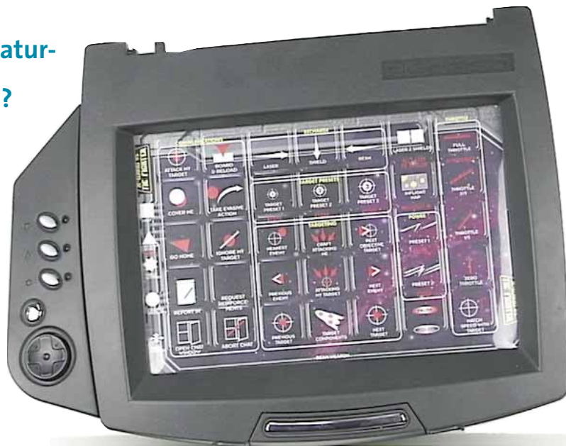
PC Dash: Unter der Klarsichtfolie liegen 35 frei belegbare Tasten. 2 Feuerknöpfe, 3 Shift-Schalter und das Steuerkreuz sind am Rand untergebracht.
