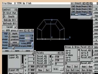
Aus handgezeichneten Vorlagen werden im Objekt-Editor Drahtgitter-Modelle erstellt.
