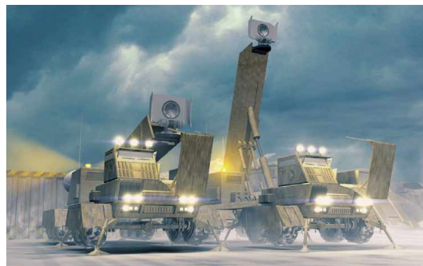
Die Lauschein-heiten werden zur Abschwä-chung von Störimpulsen vom Boden gehoben.
