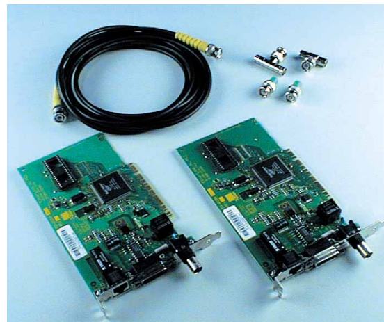
Das brauchen Sie für zwei PCs: Zwei Netzwerkkarten (je ca. 40 Mark), zwei T-Stücke (je ca. 8 Mark), zwei Terminatoren (je ca. 5 Mark) und ein Kabel , 10 Meter kosten ca. 20 Mark).
