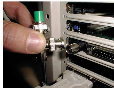
Schritt 3: Ein T-Stück mit bereits angesetztem Abschlußwiderstand wird an die BNC-Kupplung der Netzwerkkarte angebracht.
