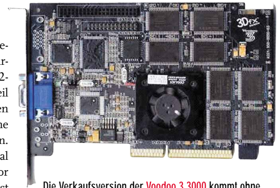
Die Verkaufsversion der Voodoo 3 3000 kommt ohne Aktivkühler und dafür mit TV-Ausgang.
