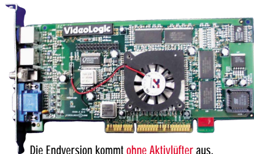
Die Endversion kommt ohne Aktivlüfter aus.
