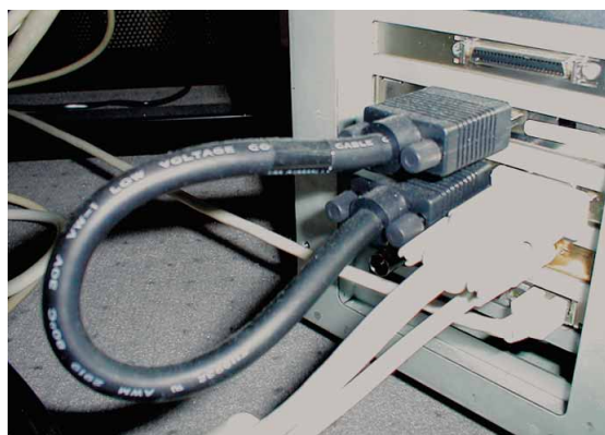
Achten Sie auf eine knickfreie Anbringung des Loop-Kabels.
