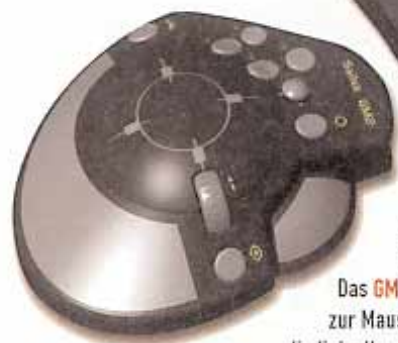
Die GM1-Maus von Saitek hat als Besonderheit einen Coolie Hat in der Daumenmulde.
