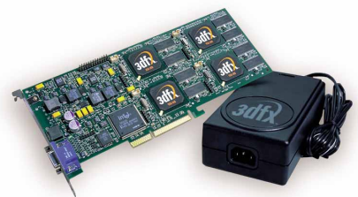
Leistung satt durch eigene Stromversorgung: Voodoo 5 6000 AGP mit vier VSA100-Chips.
